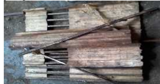
Gambar 8. Pembatas Yang Dilekatkan Kertas Prespan
