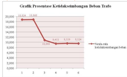
Gambar 4.14 Prosentase Ketidakseimbangan Beban 4.3. Arus Netral Trafo
