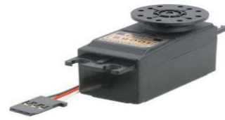
Gambar 3 Motor servo sebagai penggerak lengan robot
