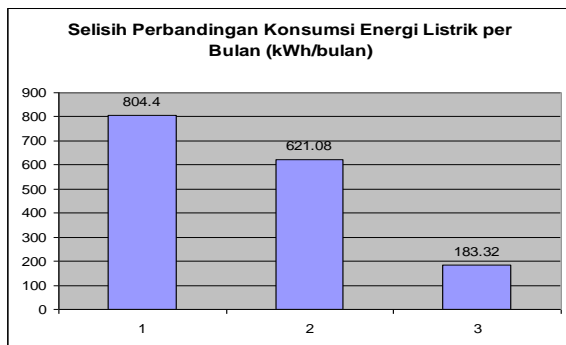
Gambar 13 Selisih perbandingan konsumsi energi listrik antara tanpa pengendalian dengan pengendalian sensor PIR selama satu bulan
