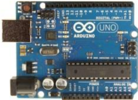
Gambar 3 Board Mikrokontroler Arduino Uno AVR ATmega 328
