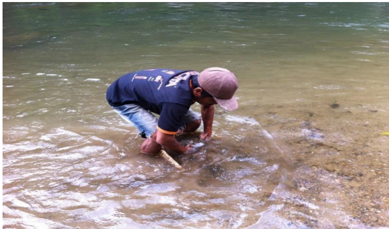
Gambar 6. Pengambilan sampel bedload
