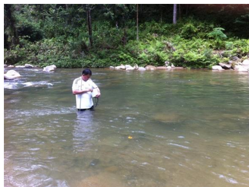
Gambar 3. Pengukuran kecepatan dengan current meter
