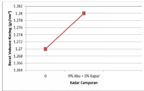
Gambar 8. Grafik pengaruh persentase abu cangkang sawit dan kapur terhadap nilai berat volume kering maksimum (MDD)
